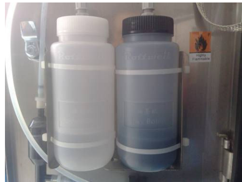
Fig. 5-3 ขวดเมคอัพและขวดหมึกในเครื่อง
