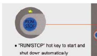
Fig. 6-12 ตำแหน่งเพาเวอร์สวิตช์ และปุ่มรันสต็อป "RUN/STOP"
