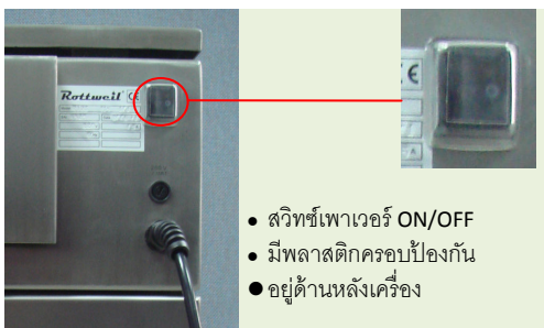
Fig. 6-12 ตำแหน่งเพาเวอร์สวิตช์ และปุ่มรันสต็อป "RUN/STOP"
